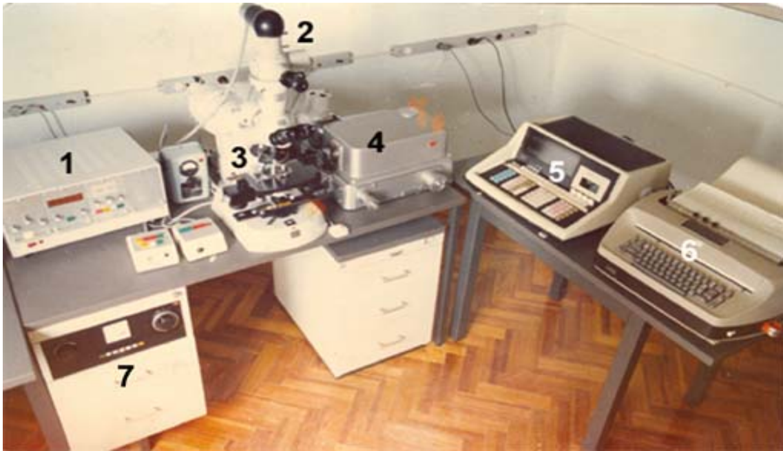
Fig. 34. Incorporación en 1975 del Citoespectrofotómetro de Zeiss MP01 de exploración asociado en línea a una calculadora programable Wang y al sistema de microscopio. Con este aparato pudimos desarrollar un primer programa para el sistema computacional a nivel internacional destinado al análisis cuantitativo de los cromosomas (292). 1 , Módulos electrónicos de comando; 2 , sensor fotomultiplicador; 3 , sistema de microscopio con platina motorizada para exploración del objeto; 4 , monocromador para iluminación a longitudes de onda del espectro visible; 5 , calculadora programable conectada en línea con el sistema, 6 , impresora de datos cuantitativos obtenidos durante el análisis; 7 , controles del fotomicroscopio.
